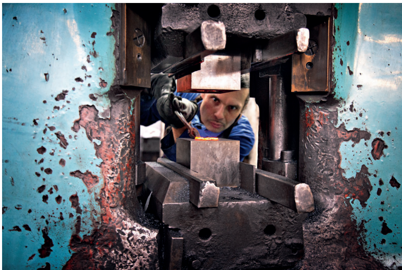
KOVÁŘ Koho jiného byste u výroby nožů mohli potkat než mistra bojových umění? Luděk Šulda, hlavní kovář KDS, vede v Sedlčanech školu kung-fu Hung Kar. V jeho železných kleštích se nůž do strojků na maso právě přesunuje z výhně do kovacího bucharu.
