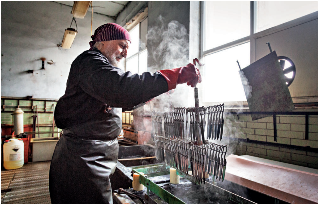
V NIKLOVNĚ Vládcem niklovny je Zdeněk Novotný, který se proplétá mezi několika typy lázní, jimiž musí výrobky projít – odmašťovací, oplachovací, niklovací a konzervační – pak teprve poniklované výrobky suší a posílá dál k broušení a montáži.
